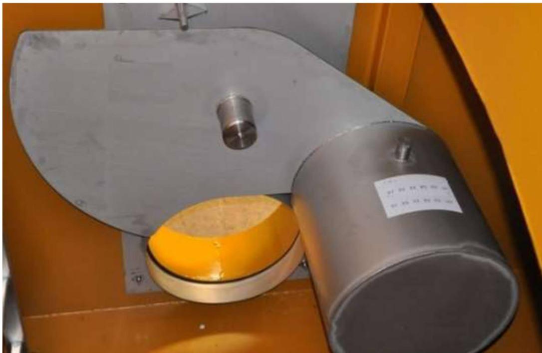
Figura 4 - valvola automatica di regolazione portata in uscita
