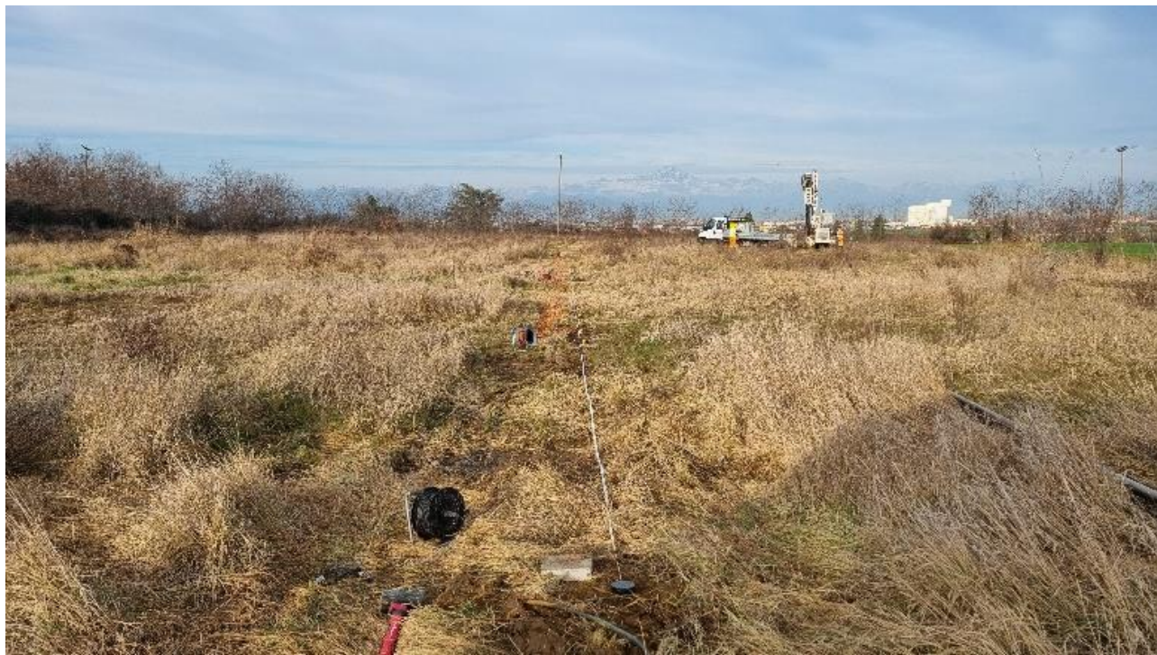
Vista dello stendimento MASW
