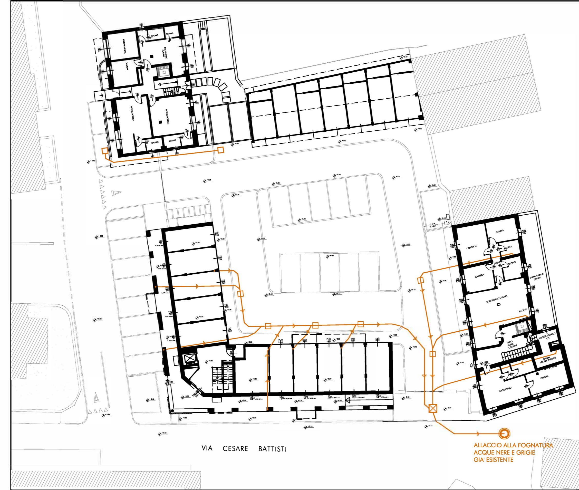
PLANIMETRIA DEL LOTTO SCALA 1 : 250 CON SCHEMA DI DISTRIBUZIONE E RACCOLTA DELLE ACQUE NERE E GRIGIE IN PROGETTO FINO AL PUNTO DI ALLACCIO GIÀ ESISTENTE
