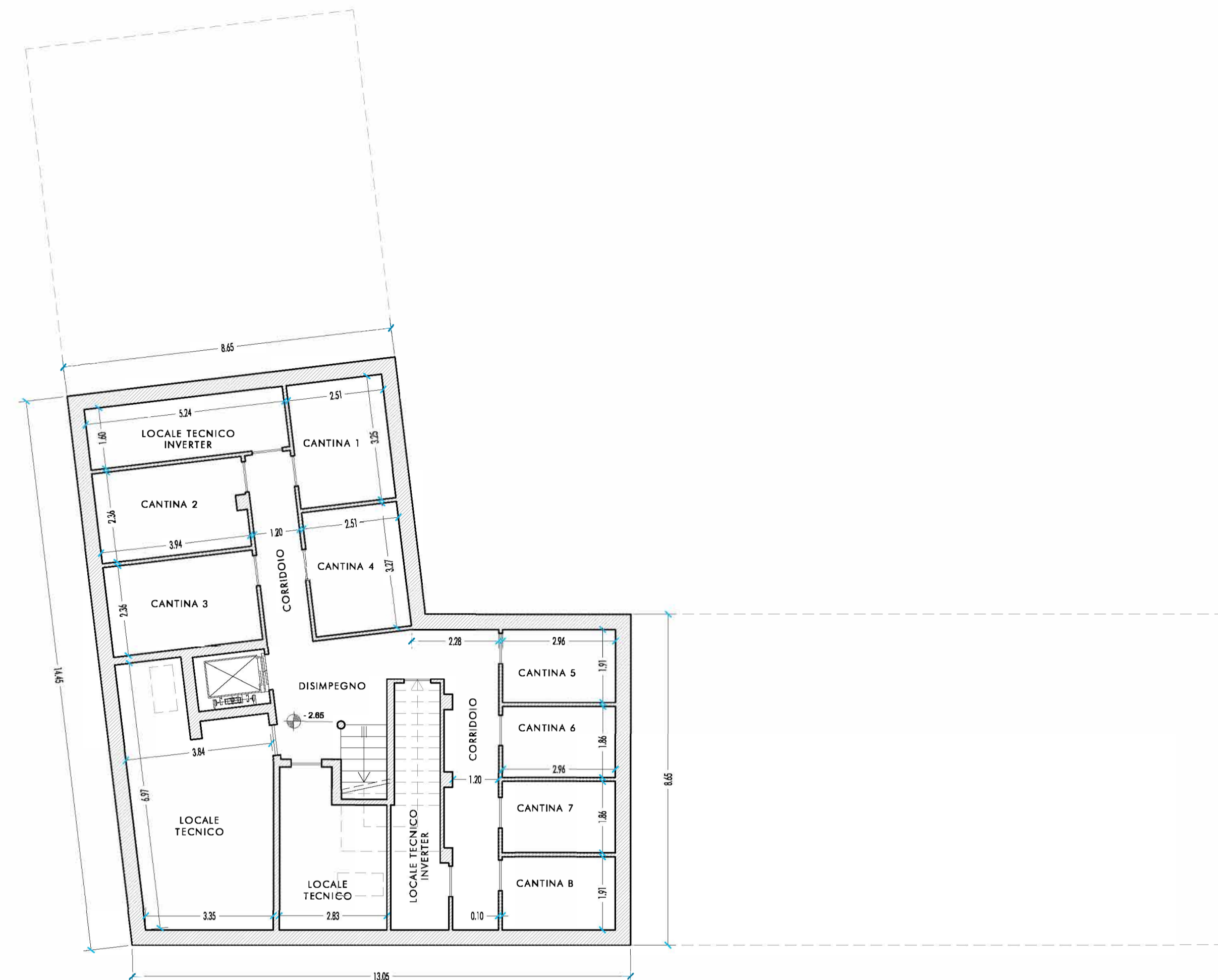
FABBRICATO PRINCIPALE - PIANTA PIANO INTERRATO
