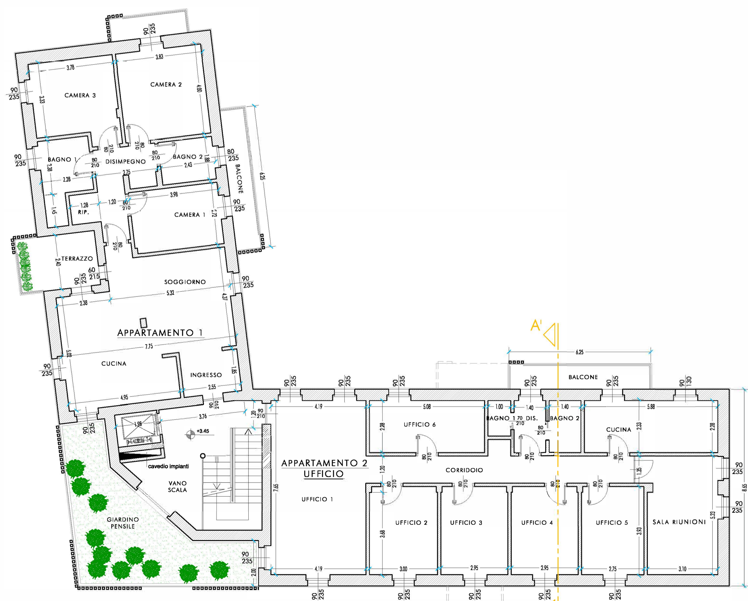
FABBRICATO PRINCIPALE - PIANTA PIANO PRIMO
