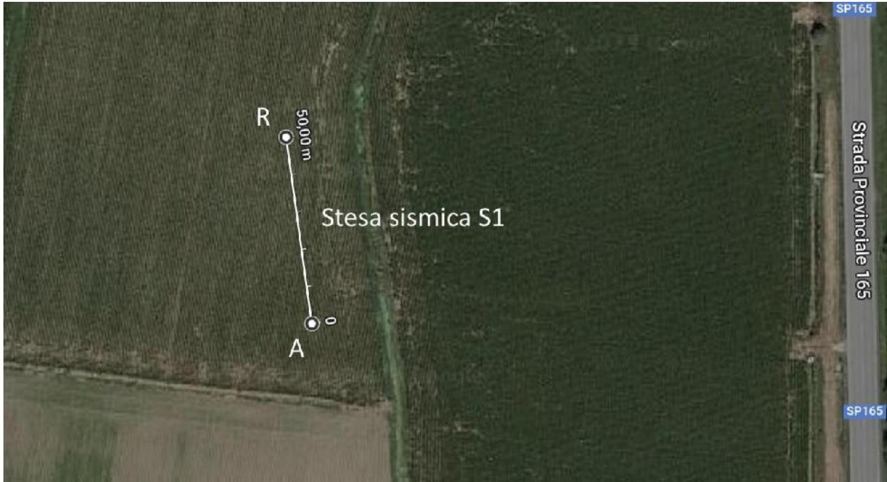
Figura n.28– Estratto foto aerea con visualizzazione dello stendimento (sismica a rifrazione e acquisizione Masw)
