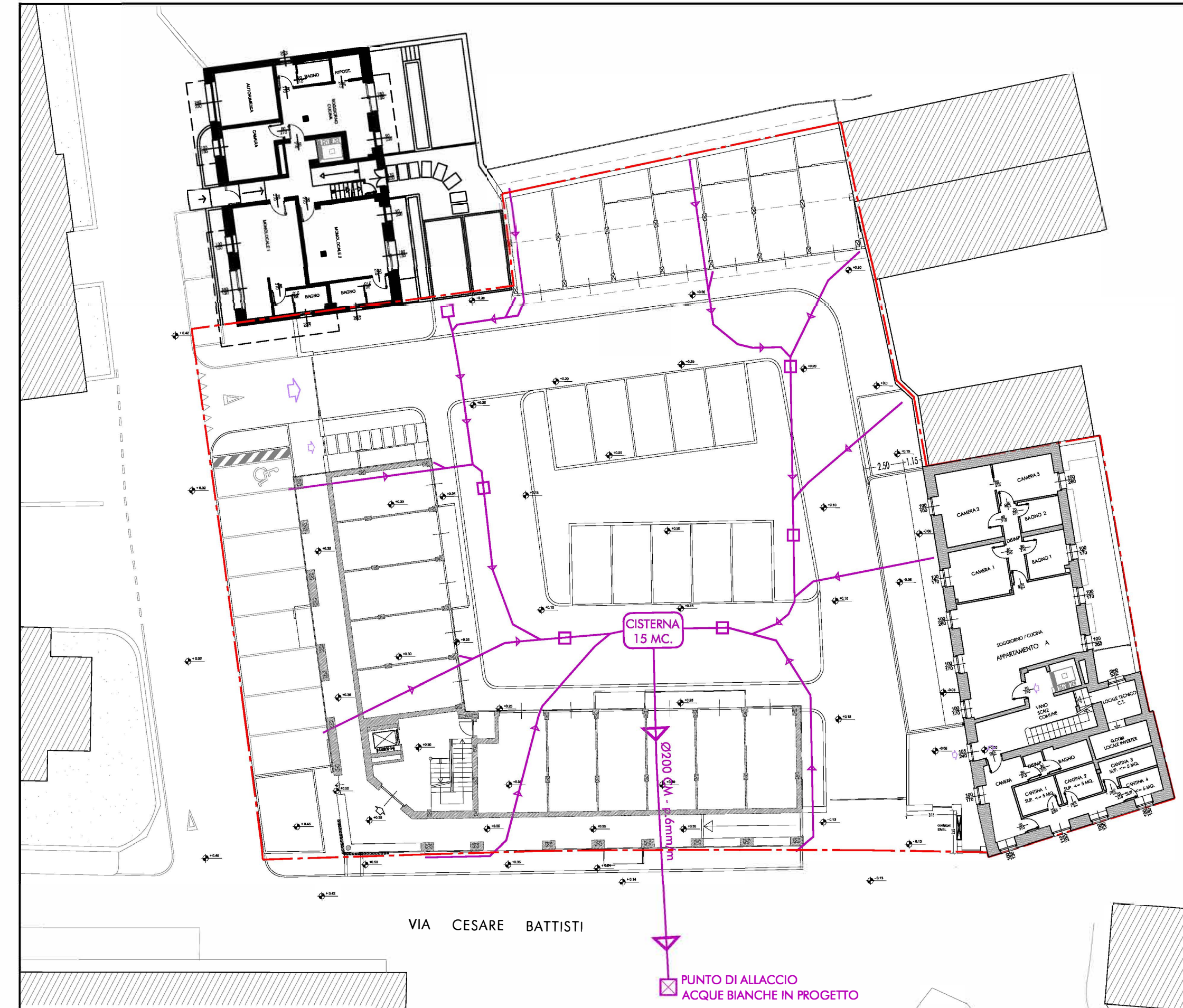
PLANIMETRIA DEL LOTTO SCALA 1 : 250 CON SCHEMA DI RACCOLTA - DISTRIBUZIONE - ACCUMULO E ALLACCIO DELLE ACQUE BIANCHE PROVENIENTI DALLE COPERTURE IN PROGETTO
