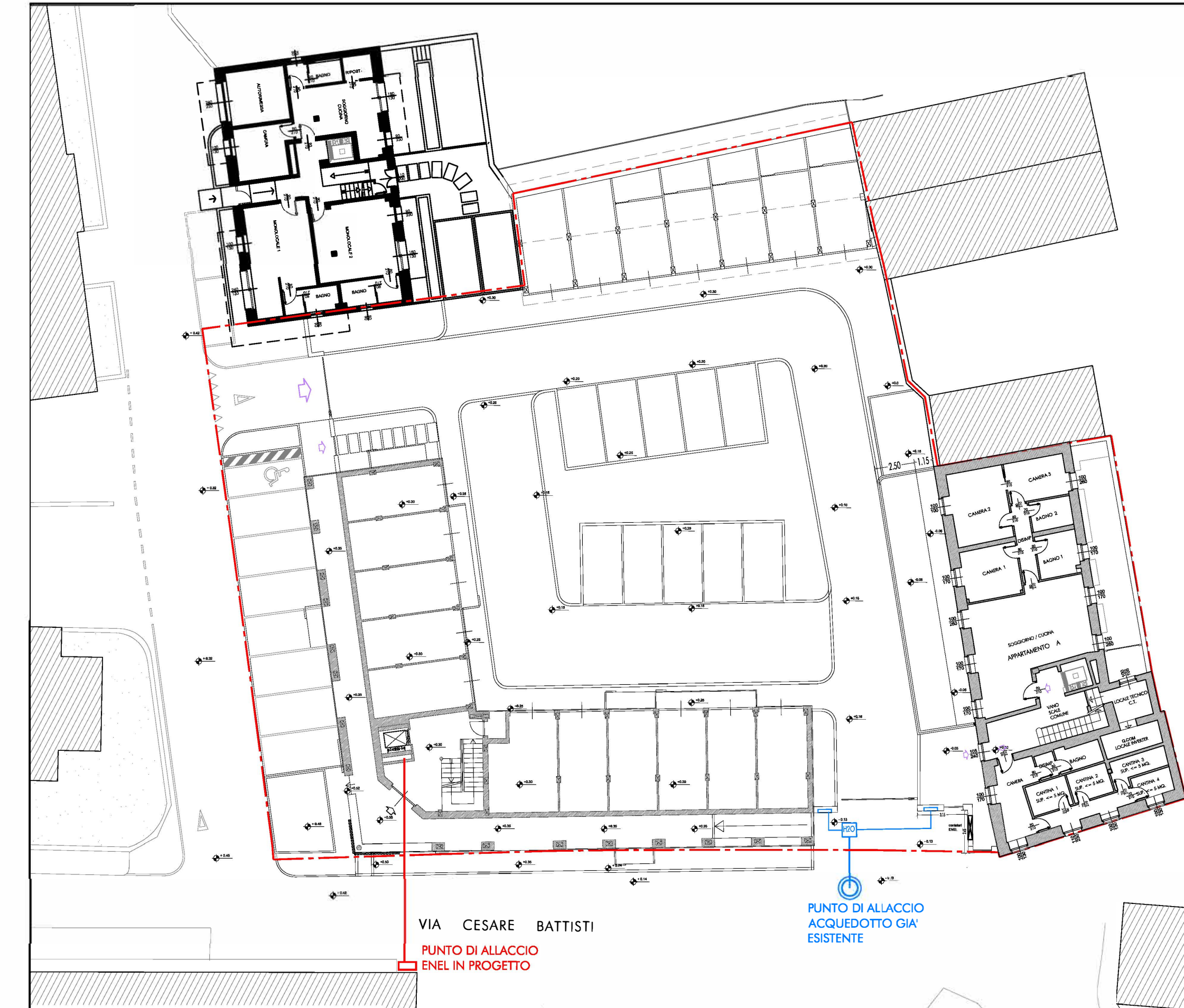
PLANIMETRIA DEL LOTTO SCALA 1 : 250 CON SCHEMA DI ALLACCIO ALLACQUEDOTTO ED ALLA FORNITURA ELETTRICA
