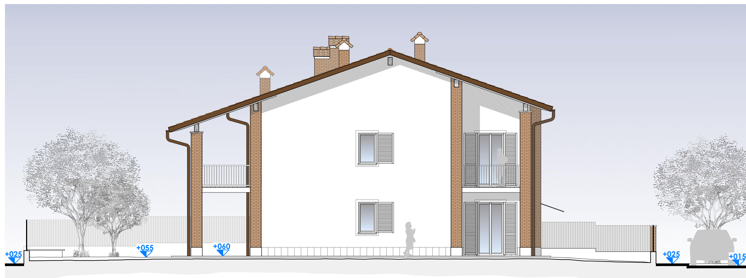
prospetto nord-est - scala 1 : 100
