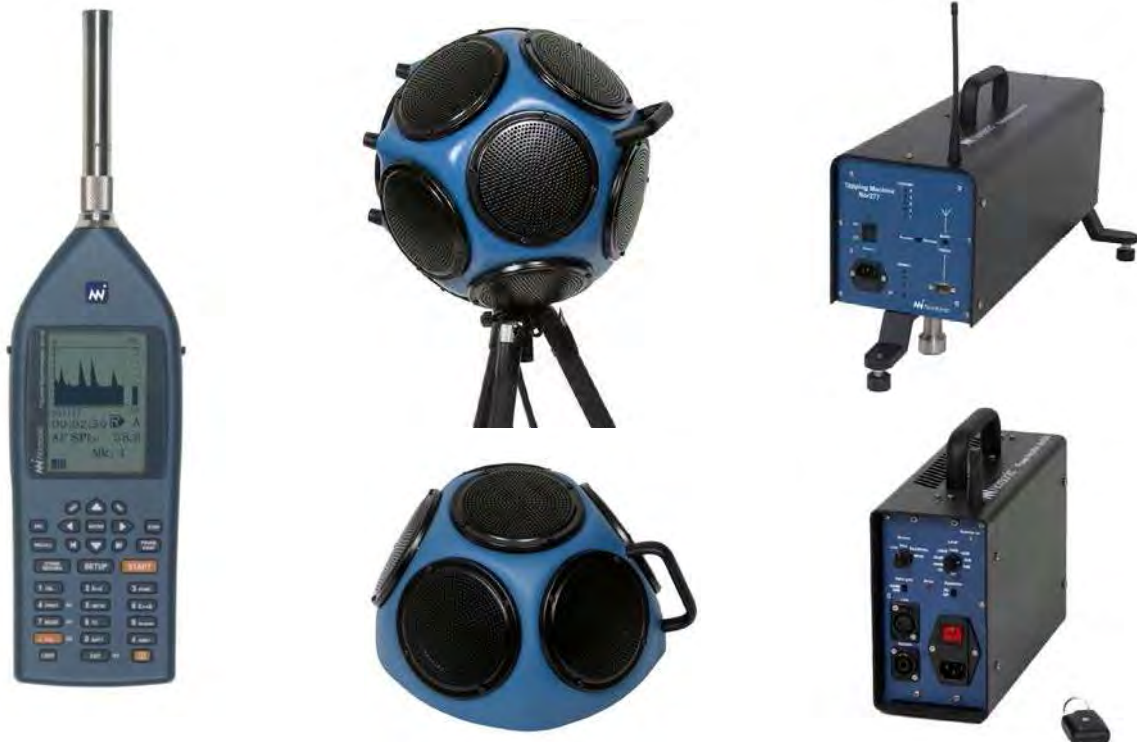
Figura 5 - Strumentazione fonometrica di proprietà Ing. Angaramo Gabriele per catena di collaudo strumentale in riferimento al D.P.C.M. 5/12/1997 "Requisiti acustici passivi degli edifici"
