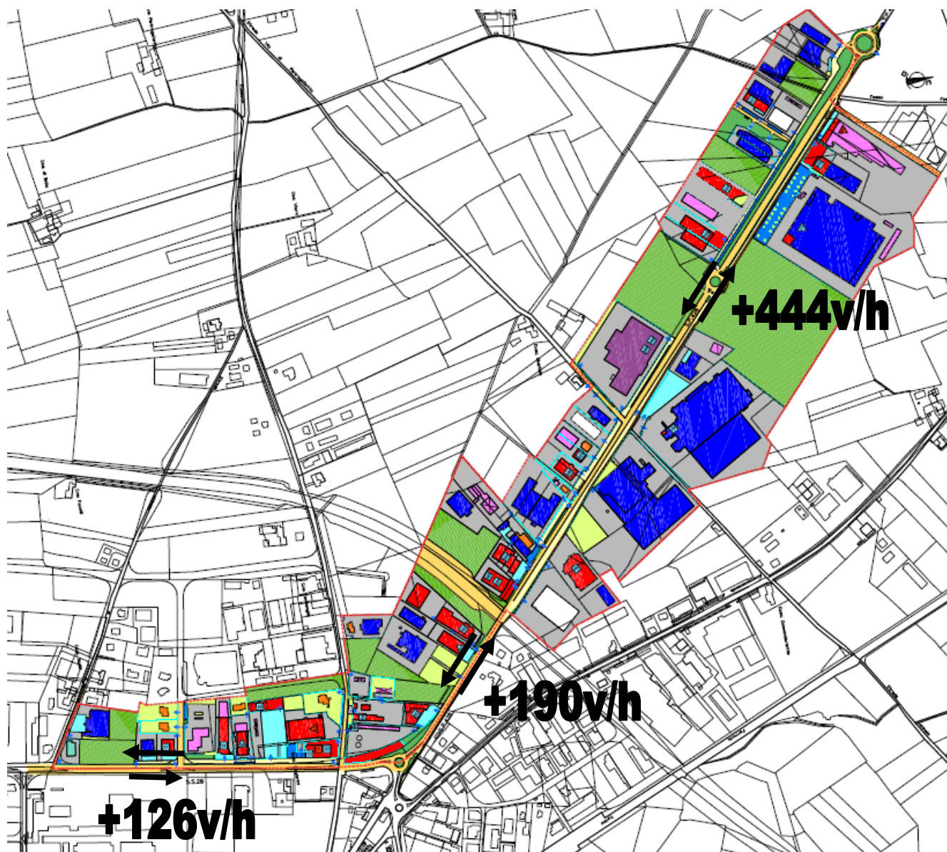
Figura 5 - integrazione dei carichi sulle direttrici principali
