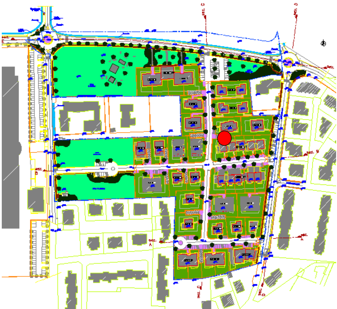
Figura 40 - punto di acquisizione fonometrica – zona centro PEC
