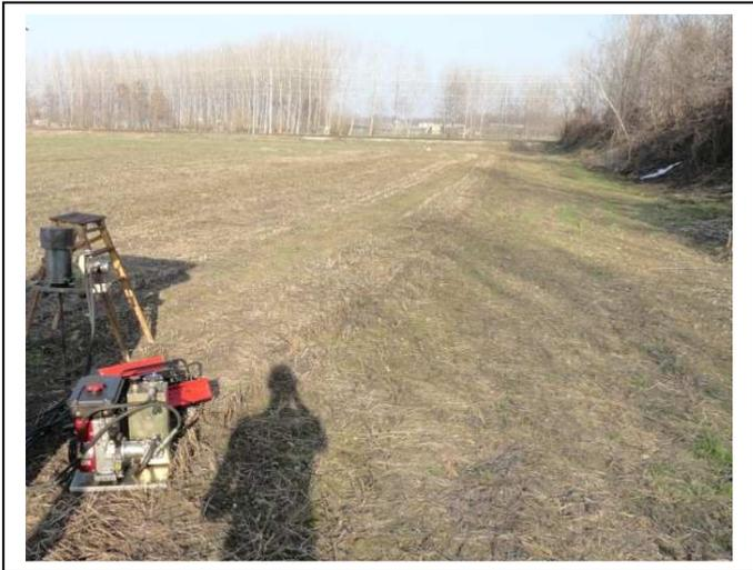
NEL SITO OGGETTO SONO STATE ESEGUITE 6 PROVE PENETROMETRICHE DINAMICHE PE VALUTARE LO SPESSORE DELLA COLTRE DI TERRENO ARGILLOSO SOPRA LE GHIAIE DEL LIVELLO FONDAMENTALE. TUTTE LE PROVE ESEGUITE HANNO EVIDENZIATO CHE IL LIVELLO ARGILLOSO HA UNO SPESSORE DI CIRCA UN METRO. LE GHIAIE DEL LIVELLO FONDAMENTALE HANNO SPESSORE DI CIRCA 50 METRI E LA FALDA E' SOGIACENTE A CIRCA 1 m.
