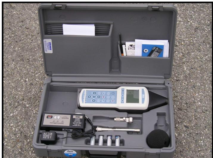
Strumentazione di misura utilizzata per i rilievi fonometrici
