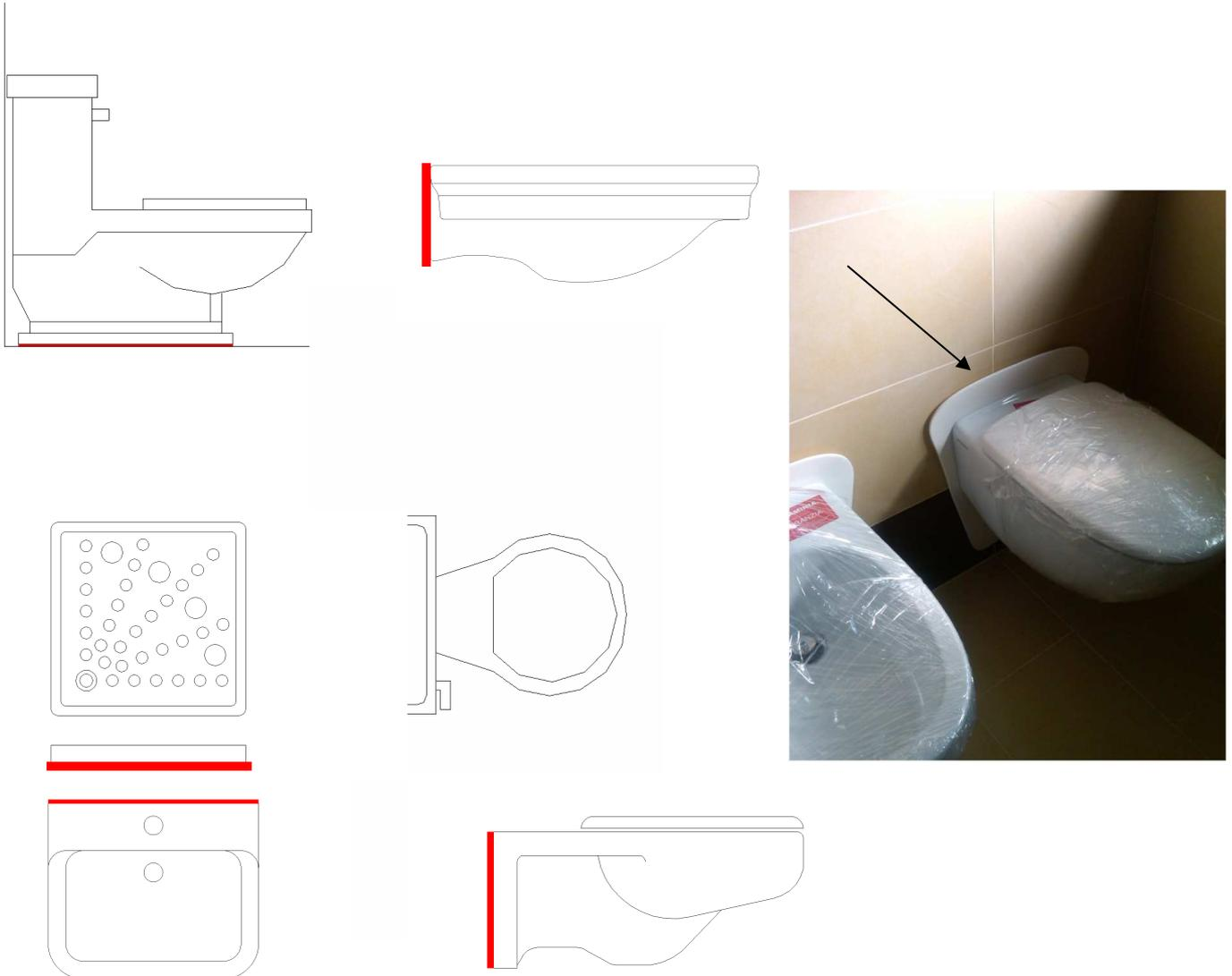
**Figura 30 – indicazione di posa delle strisce di Neoprene (MIN 4 mm)**
